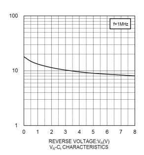
CAPACITANCE BETWEEN TERMINALS:C<sub>t</sub>(pF)
